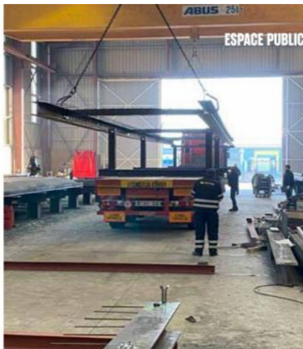
Vu leur largeur, de nombreux éléments ont quitté les ateliers par transport exceptionnel pour être acheminés sur chantier.
